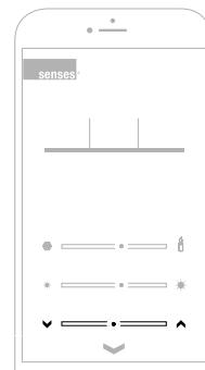
Pendant l'utilisation d'une scène sauvegardée, il est possible d'ajuster l'ambiance de l'éclairage manuellement. Malgré l'adaptation situationnelle, vos configurations enregistrées restent inchangées pour la prochaine utilisation.
